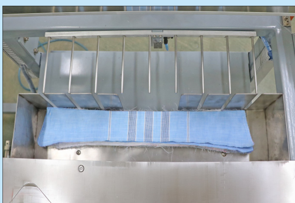
自動收料系統 Automatic collecting system
