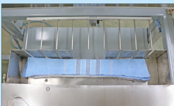
自動收料系統 Automatic collecting system
