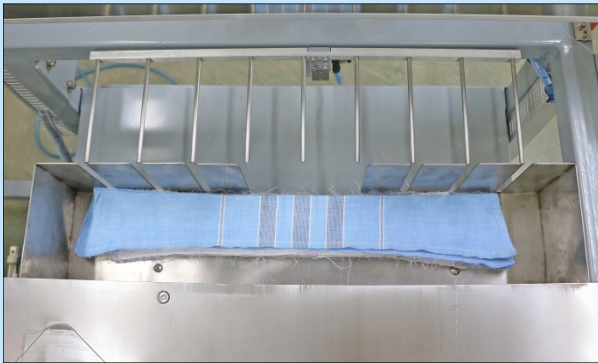
自動收料系統 Automatic collecting system
