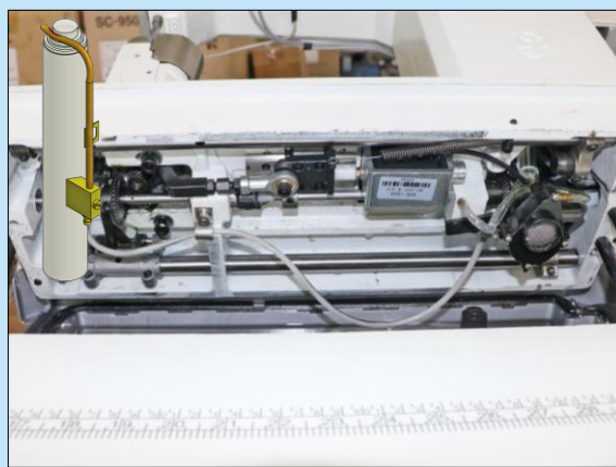
三通油路潤滑系統 T-joint oil lubrication system
