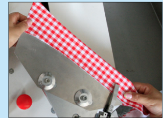
機械夾夾緊領 Automatic clamp fixing collar
