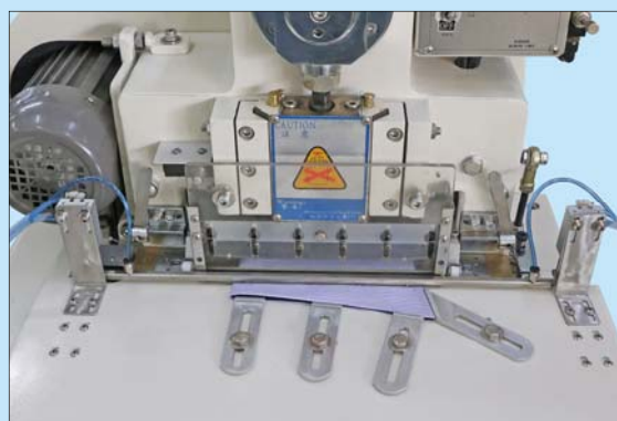
修領腳操作示意圖 Trimming operation
